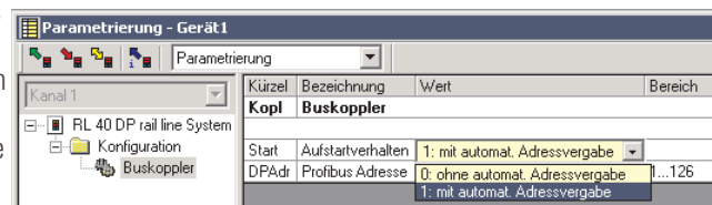
Fig. 35: Adressierungsart Buskoppler / Funktionsmodul
